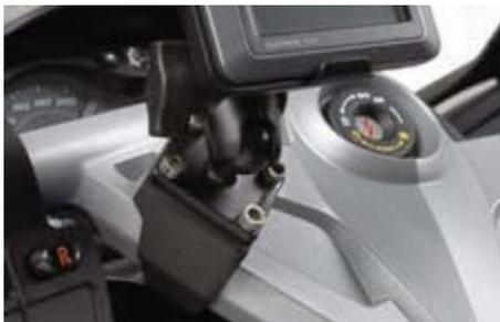
**VERSTELLBARER GPS-GERÄT-HALTERUNGSSATZ (FÜR SERIENLENKER)**
