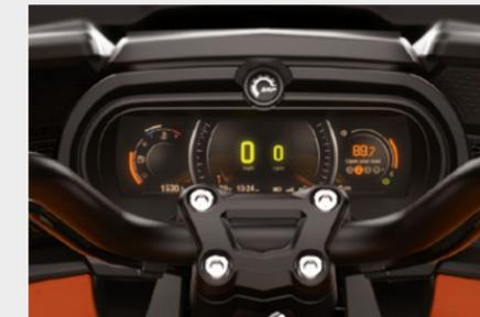
**DIGITALANZEIGE:** Großes 7,8" LCD-Panoramafarbdisplay mit BRP Connect™ zur Integration fahrzeugeteilter Smartphone-Apps wie Mediaplayer oder Navigationssystem mit Bedienung über die Lenkergriffe.
