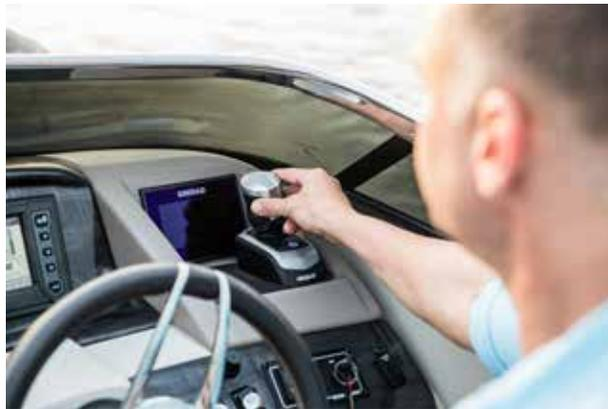
**ZWEISTUFIGER JOYSTICK:** Wenn Sie mehr Energie brauchen, um gegen Wind oder Strömung anzukommen, bringen den Joystick einfach weiter in die Boost-Position, um die Schubleistung zu verdoppeln.
