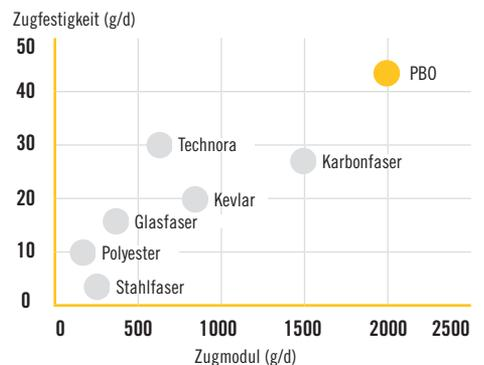
\*Verglichen mit dem Hochleistungs-Antriebsriemen von BRP (100 % PBO) (715900212).
