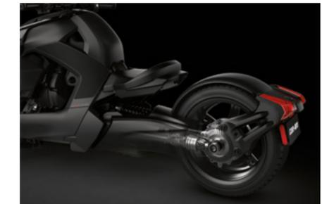
**ARBRE DE TRANSMISSION :** La technologie d'arbre de transmission extrêmement durable et robuste vous aidera à profiter d'une conduite souple tout au long du parcours. Oubliez les ajustements, les alignements et les entretiens supplémentaires.
