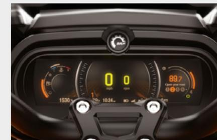
**TABLEAU DE BORD NUMÉRIQUE :** Grand écran couleur LCD panoramique 7,8 po associé à la technologie BRP Connect™ qui permet d'intégrer des applications pour smartphone optimisées pour les véhicules (applications multimédias, de navigation et bien plus encore) et d'y accéder depuis des boutons situés sur le guidon.
