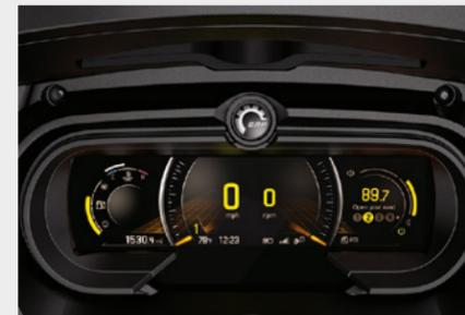
**TABLEAU DE BORD NUMÉRIQUE :** Grand écran couleur LCD panoramique 7,8 po associé à la technologie BRP Connect™ qui permet d'intégrer des applications pour smartphone optimisées pour les véhicules (applications multimédias, de navigation et bien plus encore) et d'y accéder depuis des boutons situés sur le guidon.
